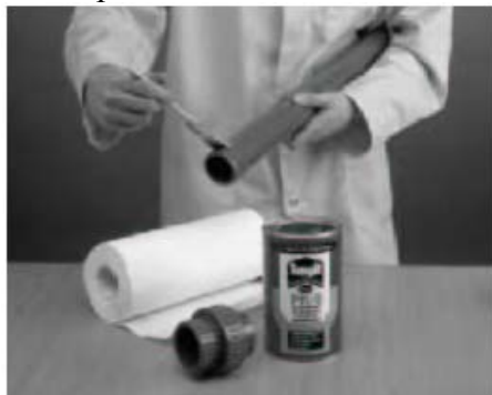
obrázek 6: nanášení lepidla při d < 90\text{ mm}
