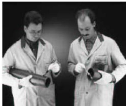
obrázek 7: nanášení lepidla při d > 110\text{ mm}
